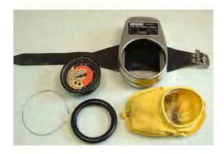
Ein zerlegter SOS Dekometer zeigt: Er funktionierte ganz ohne Elektronik und Batterien, sondern bestand im Wesentlichen nur aus einem gasgefüllten Beutel, an den mittels einem porösen Keramikfilter ein Druckmesser angeschlossen war.
