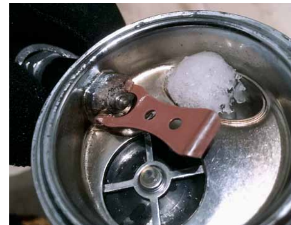
Eisbildung in einer Mares Orbiter zweiten Stufe, nach ca. 150 bar forciertem Freeflow ohne Frontabdeckung in ca. 8°C kaltem Wasser. Der für Mares-Automaten charakteristische Bypass verhindert grössere Eisbildung am Kipphebel, wie es bei anderen Automaten vorkommen kann.
